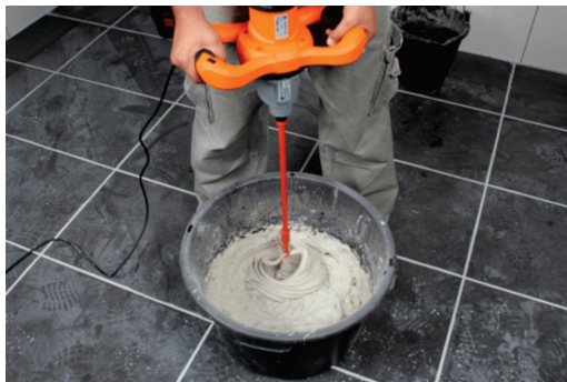
Figura 24. Prototipo de mezclador vertical con aspas
