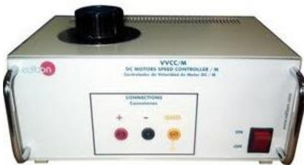
b) Control de velocidad de motores DC
