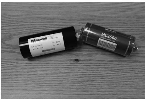
Los capacitores electrolíticos de doble capa alcanzan valores altos de capacitancia. Los que se muestran en la figura 1.10 a3),presentan capacitancias de 2600 faradios(F).
