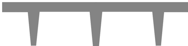
Figura 101. Tablero con vigas nervadas
