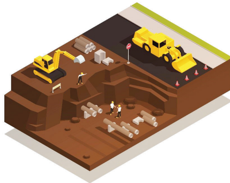
Figura 68. Instalación de conducciones con elementos prefabricados
