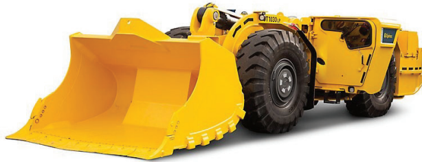
Figura 37. Cargadora de túnel
