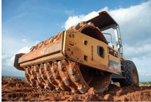
Figura 52. Compactadora pata de cabra
