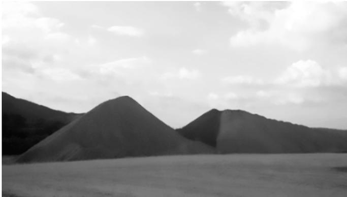
De acuerdo con el origen de los agregados, su composición, tamaño de sus partículas, forma y densidad, estos difieren de una fuente a otra; he ahí la importancia de estudiar detenidamente los materiales previamente al diseño de la mezcla, pues estos, al conformar la mayor parte del cuerpo del concreto, deben a su vez aportar una resistencia propia suficiente para garantizar la resistencia a las que estará sometido el elemento.
