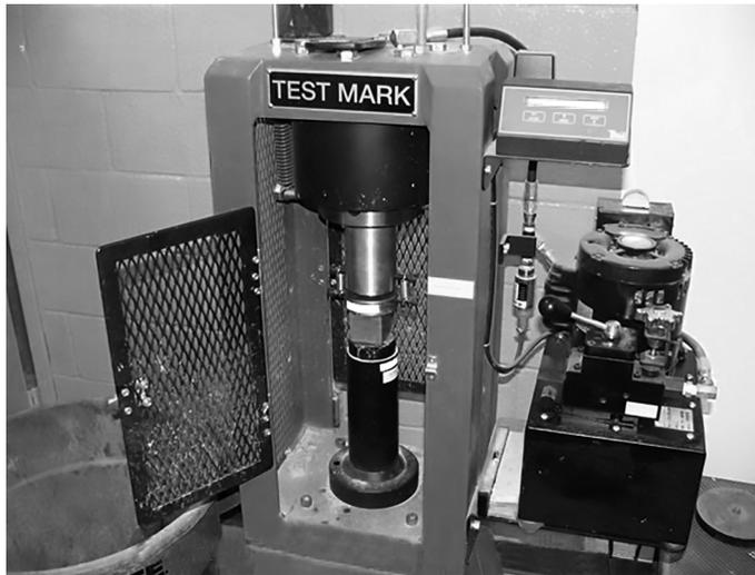
Ensayo de resistencia del cemento. Fuente: TEC Services.
