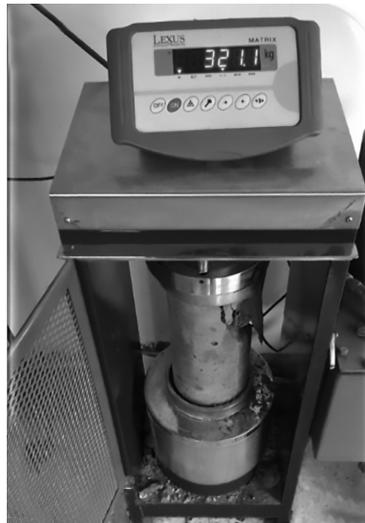
La resistencia a la compresión del concreto se determina por medio de cálculos que consideran las cargas aplicadas y las dimensiones de las muestras. Los resultados de las pruebas de resistencia se usan como criterio de calidad de los procedimientos de dosificación, mezclado y colocación del concreto, verificación de las especificaciones, evaluación de los aditivos, entre otros.
