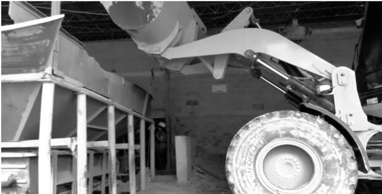
En el proceso de molienda se utilizan molinos de martillos y bandas transportadoras. En los molinos de martillos se reduce el tamaño del grano del material, y luego este es desplazado verticalmente por un elevador de cangilones hasta el tamiz de malla 10, donde se clasifica el material de acuerdo al tamaño de la partícula. La energía consumida en esta etapa es de *origen eléctrico (10.800 kW/h), con un rendimiento de 4,13 kWh/t.*
