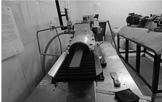
Al finalizar el proceso de corte, se puso una marca de 95 mm sobre la superficie de las probetas a fin de seguir los cambios por contracción lineal durante las etapas de secado y de cocción. Las probetas se pesaron en una balanza OHAUS Adventurer.
