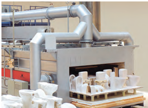
Figura 26. Secaderos en continuo para sanitarios
